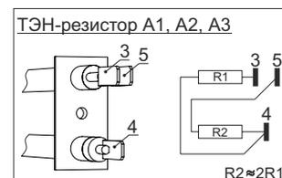
Рисунок 4. Электрическая схема завесы КЭВ-12П4060Е
